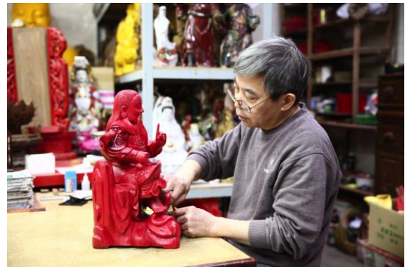
Fig. 2 As peças são lacadas e polidas várias vezes até o verniz de base estar completamente liso.
